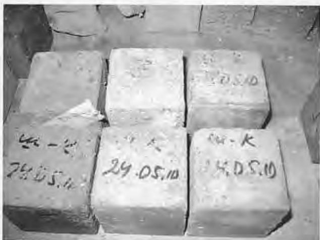
Рисунок 5. Серия образцов контрольного состава после испытаний на морозостойкость (8 циклов)
