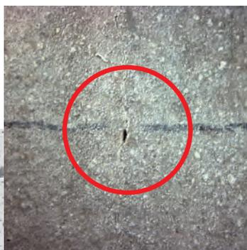
Внутри капиллярных пор бетона происходит химическая реакция активных веществ с несвязанным кальцием бетона и влагой, в результате которой образуются нерастворимые кристаллические соединения. Эти соединения закупоривают капилляры и усадочные трещины, проникая в тело бетона и становятся гидроизолирующей составляющей бетона
