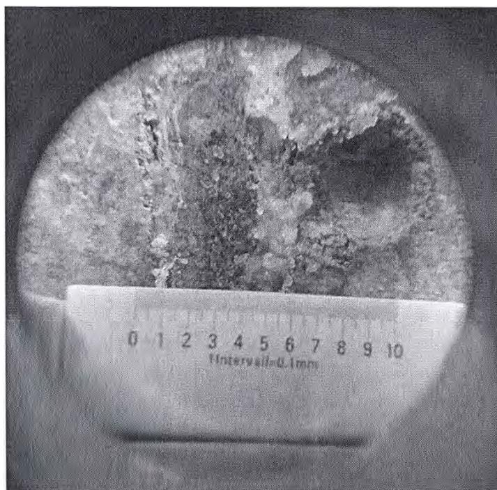
**Рис. 9.** Выросший кристалл и самовосстанавливающаяся трещина в бетоне с кристаллической добавкой Betocrete-CP360-WP
