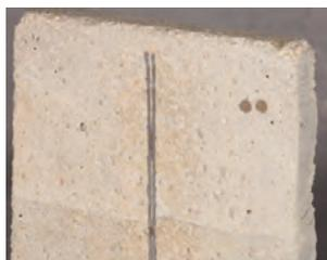
Соединение двух пластин AQUAFIN-CJ5 внутри секции бетона
