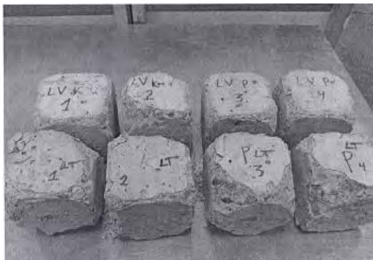
**Рис. 3.** Образцы бетона через 100 дней в растворе сульфата аммония (148 г/л). Каждый состав был представлен двумя образцами (LV вверху слева, LV-P вверху справа, LT внизу слева и LT-P внизу справа).
